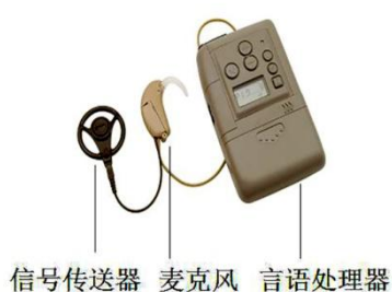
图9 人工耳蜗的体外部分
