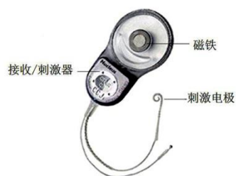
图8 人工耳蜗的体内部分
